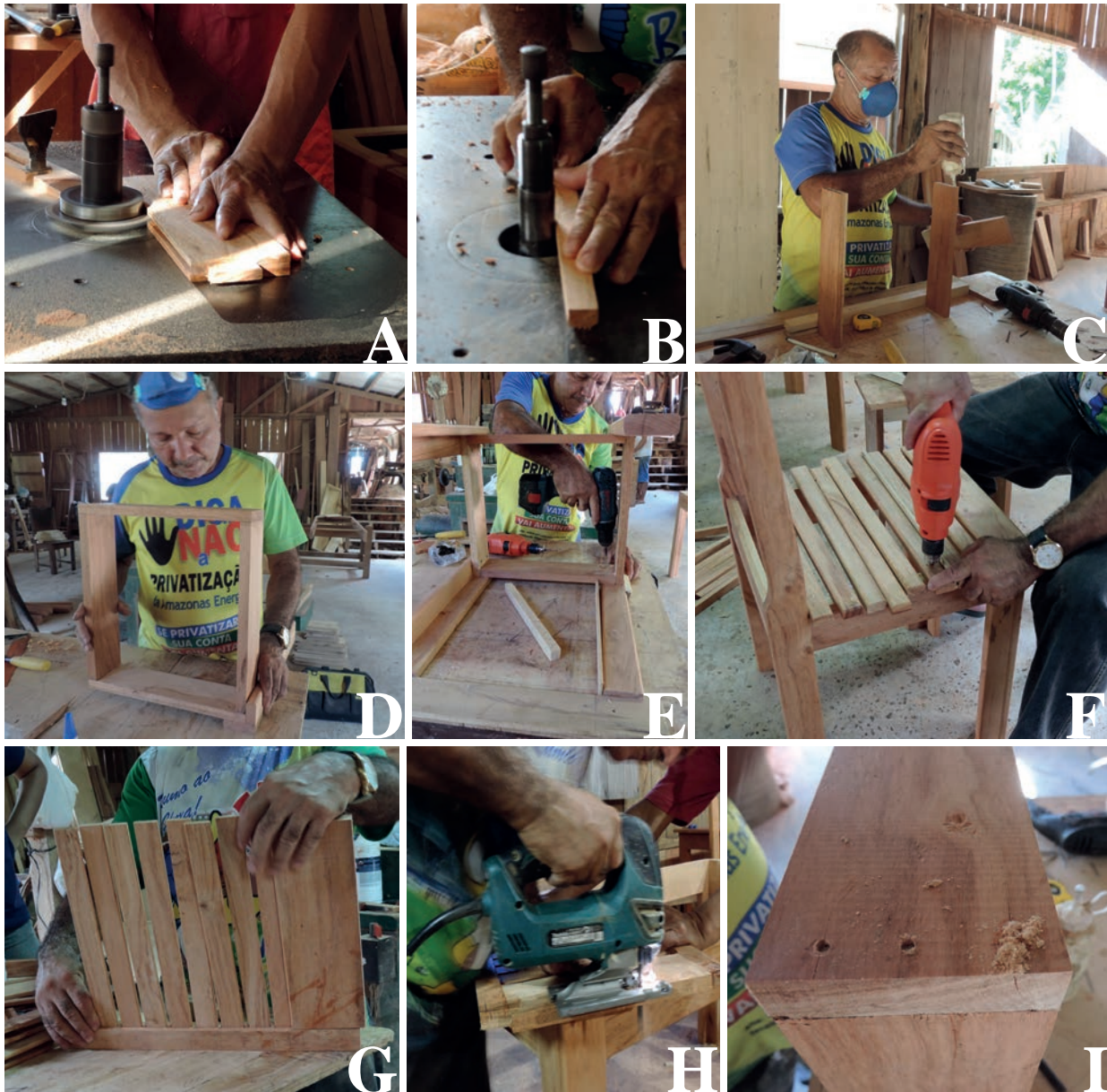
Figura 8. (A) tupia fazendo uma abertura de encaixe; (B) fresa realizando o arredondamento da borda da peça; (C) utilização de adesivo PVA; (D) confecção do esquadro e colocação das pernas; (E) perfuração com furadeira elétrica para colocação do prego; (F) perfuração com furadeira para colocação dos pregos nas ripas do assento; (G) moldando o encosto da cadeira; (H) curvatura da cadeira, feita com serra fita de mão; (I) utilização de pó de serra colados em cima da cabeça do prego.
