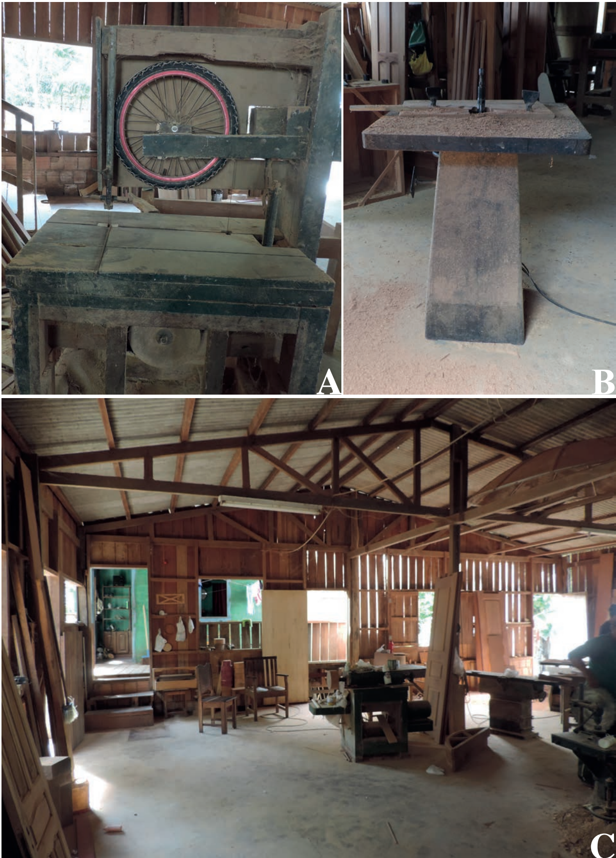
Figura 2. (A) serra fita; (B) máquina de tupia; (C) visualização da serraria de pequeno porte.
