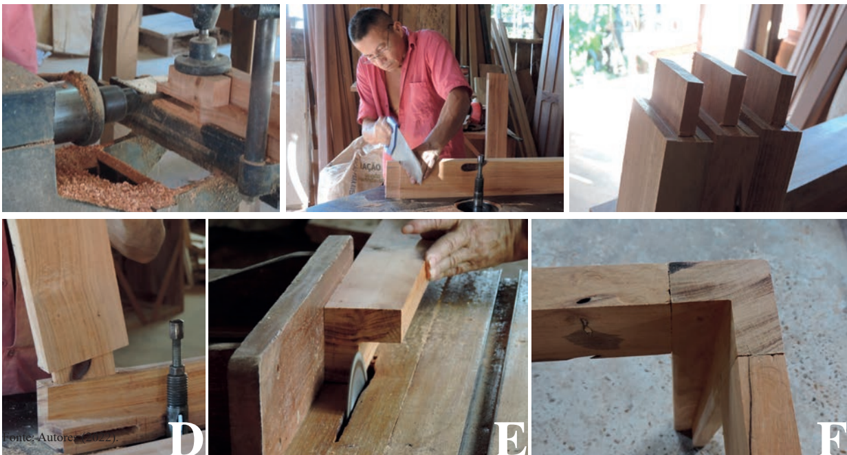
Figura 6. (A) furadeira horizontal para ligação espiga; (B) serra de mão para realização da ligação espiga; (C) estrutura da peça de madeira para o encaixe da ligação espiga; (D) encaixe entre as ligações; (E) perna da mesa em formato L; (F) ligações entre a perna e o esquadro da mesa.
