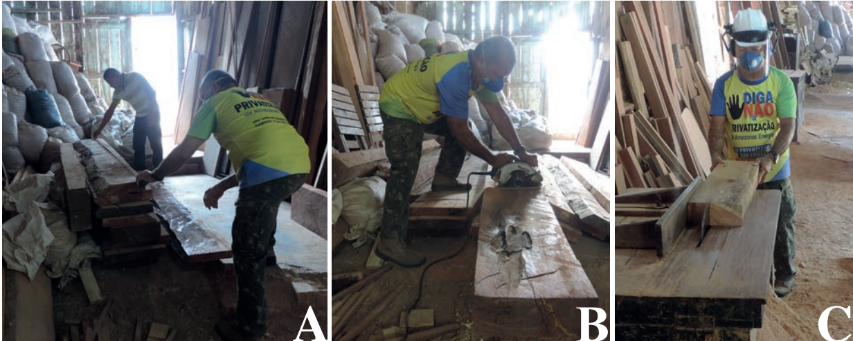
Figura 5. Seleção e dimensionamento das peças de madeira para o desenvolvimento dos produtos: (A) verificação do comprimento das peças; (B) corte da madeira com serra circular manual; (C) corte com serra circular de mesa.
