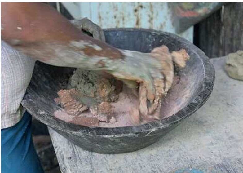
Figura 13. Mistura do chamote com o barro.
